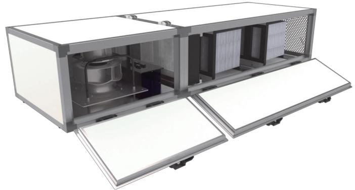
Standardmäßig ist das Umluftgerät mit 1x Vorfilter (Aktivkohle), 1x EC Radialventilator, 1x Ozonerzeuger Typ LH-ABB6.1, 1x Niederdrucksensor, 1x Panel-Filter M5, 1x V - Zellenfilter F7, 2x Ionenerzeuger Typ LH-MAG 1000, 1x Bio - Speichermasse, 2x Ionenerzeuger Typ LH-MAG 1000 bestückt.
